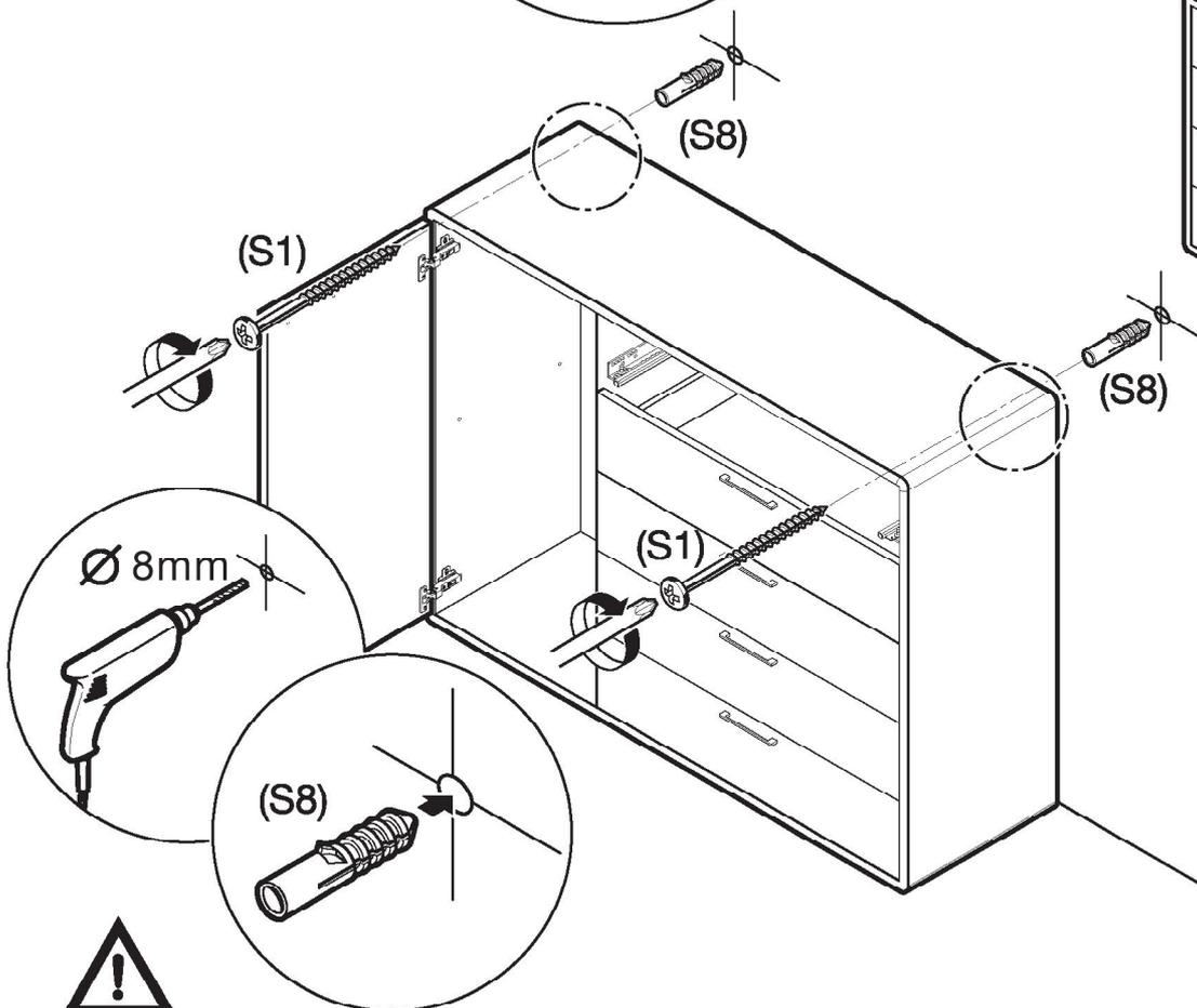
Das beiliegende Montagematerial (Schrauben und Wanddübel) ist nur für Massivwände geeignet. Informieren Sie sich vor der Wandmontage über das geeignete Montagematerial für Ihre Wand.
