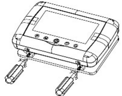
1. Montageplatte mittels beiliegender Schrauben entweder direkt in die Wand (mit Dübel) oder auf Schalterdose schrauben.
