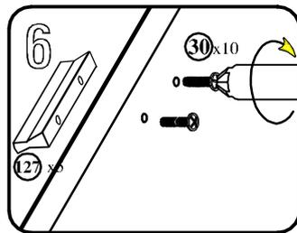
Die beigefügten Dübel zum Aufhängen des Elements dürfen nur bei Betonwänden eingesetzt werden, bei anderen Wandarten müssen entsprechende Dübel zugekauft werden.
