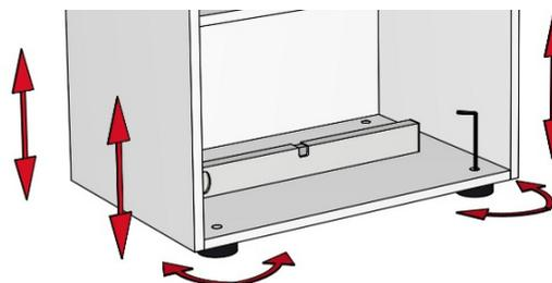
Frontteile (Schubkästen, offene Fächer, Türen) ausbauen. Möbelgleiter durch Drehen im Uhrzeigersinn auf den Nullpunkt stellen, horizontal und vertikal ausrichten. Korrekturen von innen mittels Inbusschlüssel SW4 oder von außen mit Hand vornehmen. Löcher mit Abdeckkappen schließen.
