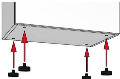
Transportschutz unterhalb des Sockelbodens abschrauben. StellfüÙe / Möbelgleiter (Teile Nr.: 50611) mit dem Zapfen in den Sockelboden setzen.
