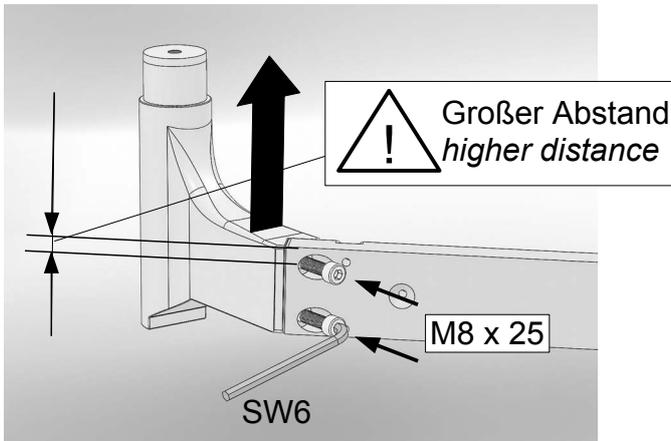
5. Die Traverse so mit dem Fuß verbinden, dass sich der große Lochabstand auf der Seite des Fuß-Anschlusses (s.a. Bild!) befindet. Die beiden Befestigungselemente beim Anschrauben **nach oben drücken**.
