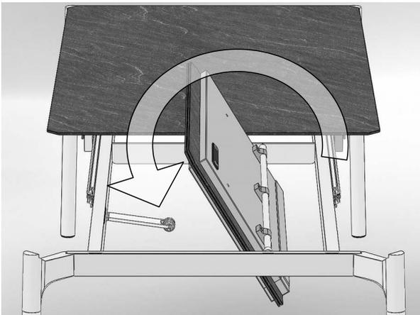
21c. **Beide** Halbteile **gleichzeitig** zurückklappen. Mit dem Ledergriff ganz ausklappen und die Höhe kontrollieren. Ggf. erneut justieren.
