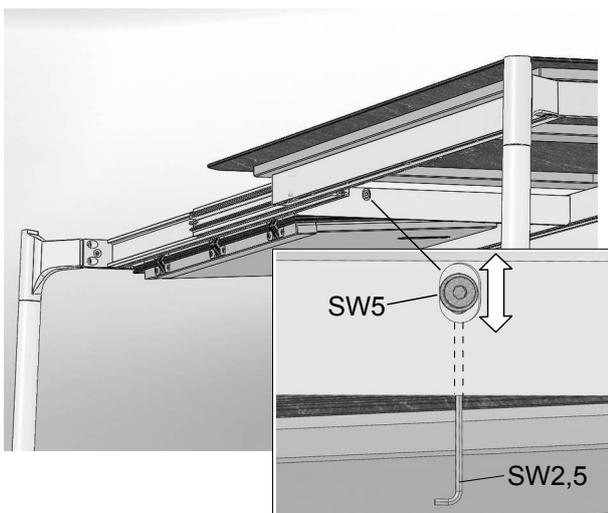
13. ... die Inbusschraube lösen. Nun durch Drehen der in der Traverse befindlichen Inbusschraube (SW2,5) die Höhe der Drehstange einstellen. Anschließend die Inbusschraube der Drehstange wieder festziehen.
