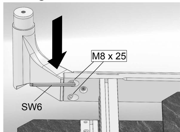
8. Die beiden Füße mit je zwei Schrauben und dem mitgelieferten Inbusschlüssel befestigen. Die beiden Füße beim Anschrauben **nach unten drücken**.
