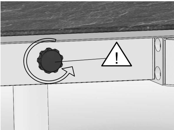
15. Vor dem Ausziehen auf beiden Seiten die schwarzen Bremsschrauben lösen.
