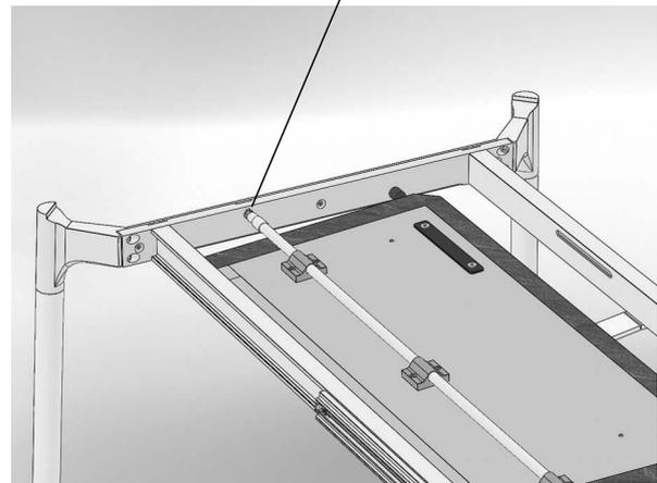
18. Wenn nötig, auch die gegenüberliegende Lagerung der Drehstange justieren. Dazu ggf. die Hülse nach hinten ziehen und dann mit einem Maulschlüssel die Mutter etwas lösen.
