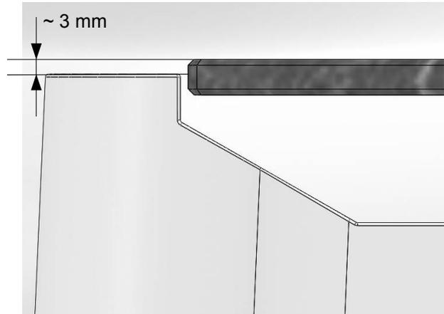
10. Prüfen, ob die Hauptplatte gegenüber den Tischbeinen etwa 3 mm höher ist. Die Tischbeine können nach dem Lösen der Schrauben (s.a. P. 3 + 4) vertikal etwas verschoben werden. Anschließend die Schrauben wieder festziehen.
