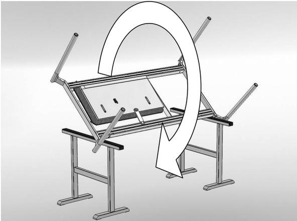
5. Den Tisch wenden, ohne die FüÙe zu belasten und dann gleichzeitig alle 4 Tischbeine auf dem Boden absetzen.
