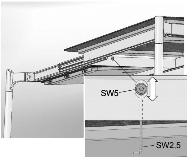
17. ... die Inbusschraube lösen, die Drehstange entsprechend justieren und die Inbusschraube wieder festziehen.
