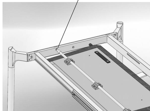
14. Wenn nötig, auch die gegenüberliegende Lagerung der Drehstange justieren. Dazu ggf. die Hülse nach hinten ziehen und dann mit einem Maulschlüssel die Mutter etwas lösen. Nun durch Drehen der in der Traverse befindlichen Inbusschraube (SW2,5) die Höhe der Drehstange einstellen. Anschließend die Mutter der Drehstange wieder festziehen.
