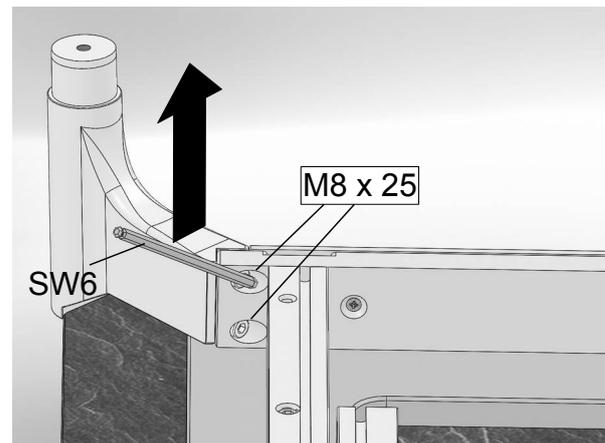
4. Die beiden Tischbeine mit je zwei Schrauben und dem mitgelieferten Inbusschüssel befestigen. Die Tischbeine beim Anschrauben **nach oben drücken**.
