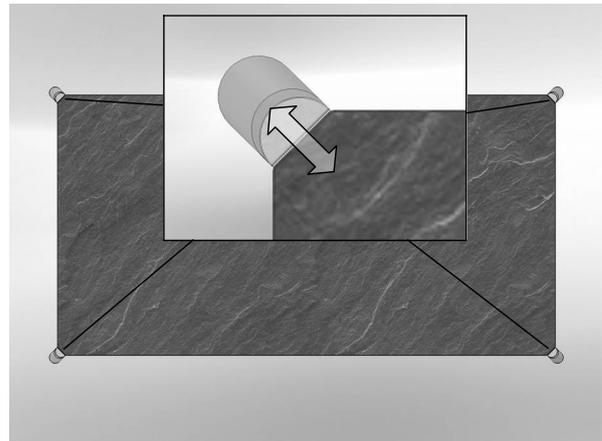
8. ... die Platte gleichmäßig zu den Fuß-Befestigungselementen ausrichten und **erst dann** ...
