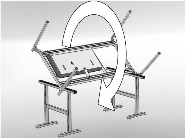
9. Den Tisch wenden, ohne die FüÙe zu belasten und dann gleichzeitig alle 4 Tischbeine auf dem Boden absetzen.
