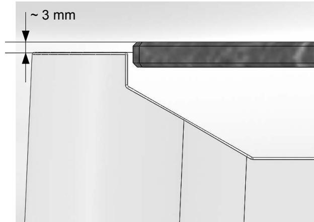
14. Prüfen, ob die Hauptplatte gegenüber den Füßen etwa 3 mm höher ist. Die Füße können nach dem Lösen der Schrauben (s.a. P. 5 + 8) vertikal etwas verschoben werden. Anschließend die Schrauben wieder festziehen.
