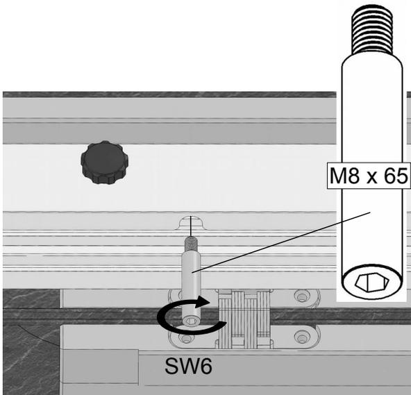
7. Die Platte mit den 6 Schrauben **zunächst lose** anschrauben ...
