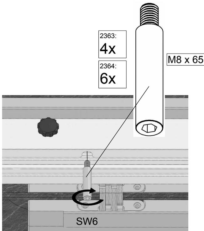
11. Die Platte mit den Schrauben **zunächst lose** anschrauben ...
