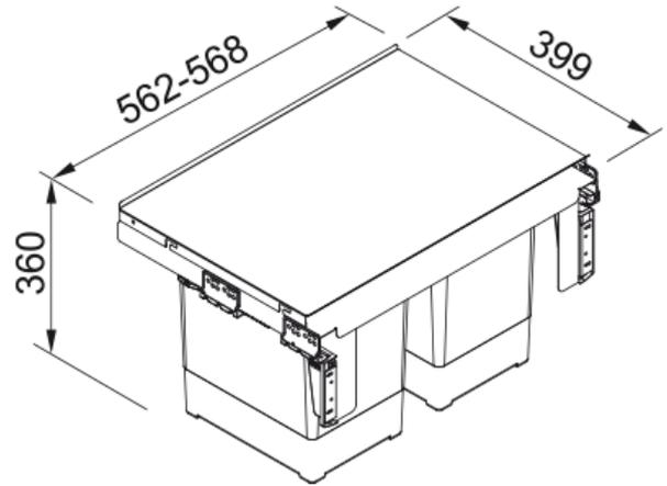
Sorter Garbo 60, 2-fach Trennung 2x18 Liter Unterbau 60 cm, Stabile Metallabdeckung mit Ablagemöglichkeit
