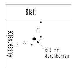
Bitte befestigen Sie die Möbel mit den beiliegenden Schrauben (5x90) am Mauerwerk (Kippsicherung). Hierfür ist in der oberen linken und rechten Ecke eine Verstärkung hinter der Rückwand angebracht.
