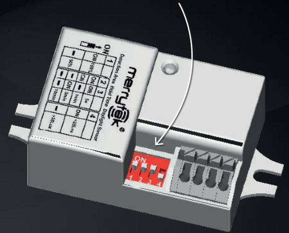
Mit Hilfe der 4 DIP-Schalter lässt sich der Bewegungsmelder in den Bereichen Empfindlichkeit (Erfassungsbereich), Einschaltdauer und Helligkeitsschwelle (< > 25 Lux) konfigurieren.
