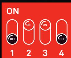
Bei erfasster Bewegung im Radius von 4m (bei angegebener Maximal-Reichweite von 8m) schaltet der Sensor die Leuchte bei Tageslicht für 5 Sekunden ein!
