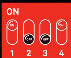
Bei erfasster Bewegung im Radius von 8m (bei angegebener Maximal-Reichweite von 8m) schaltet der Sensor die Leuchte bei Dunkelheit für 10 Minuten ein!
