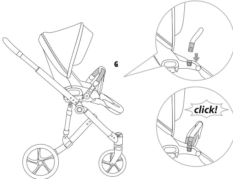
Odstranitev varovala / Demontering av skyddsbygeln / Demontaža sigurnosne prečke / Demontaža sigurnosne prečke / Demontáž ochranného madla /
