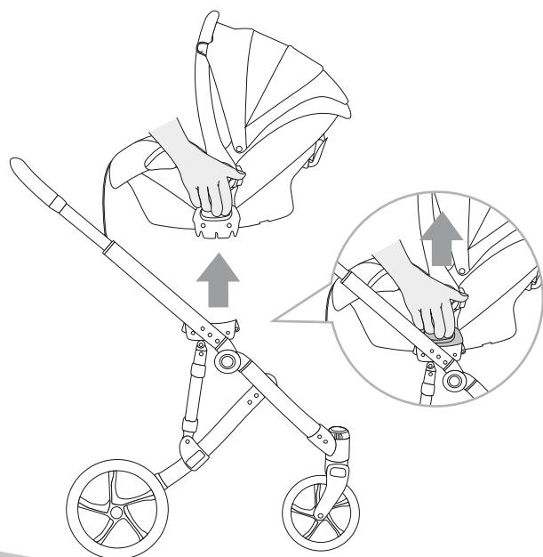
Odstranitev adapterja / Demontering av / Demontaža adaptera / Demontaža adaptera / Demontáž adaptéru
