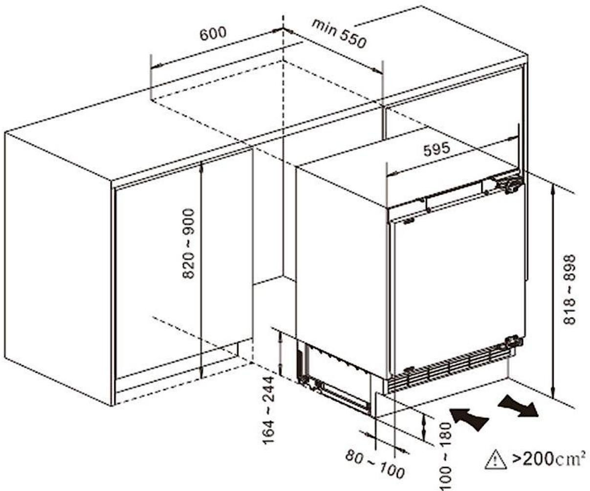
ERFORDERLICHE BELÜFTUNGSÖFFNUNG =  $>200\text{ cm}^2$
