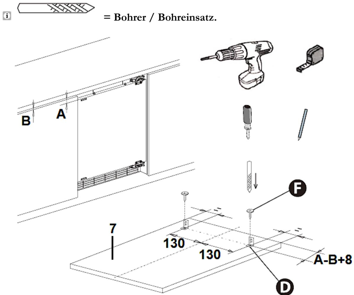
11. Hängen Sie die Tür des Einbaumöbels « 7 » mit den installierten BAUTEILEN « **D** » in die BAUTEILE « **B** » der Gerätetür « 8 » ein; s. Abb. unten.
