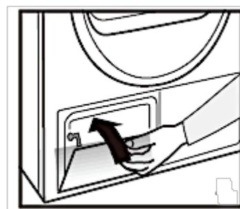
5. Verriegeln Sie den Kondensator ordnungsgemäß.
