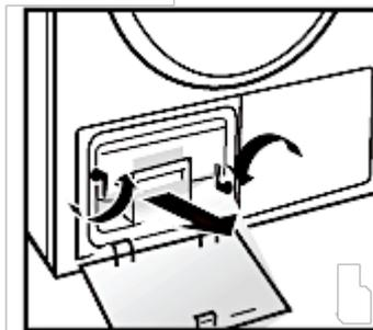
3. Reinigen Sie den Kondensor gründlich unter fließendem Wasser. Entwässern Sie den Kondensor sorgfältig.
