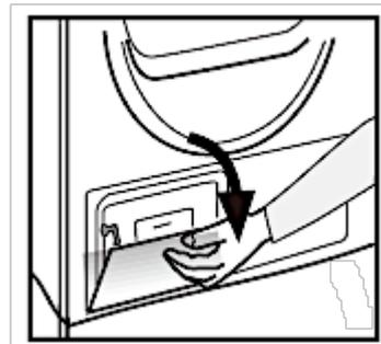
2. Schrauben Sie die Verriegelungen auf beiden Seiten ab und ziehen Sie den Kondensor heraus.
