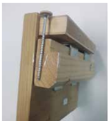
Variante für Einhängeleisten: Diese mit einer Schraube von oben sichern und anschließend die Holzabdeckung auf dem Schraubenkopf stecken.
