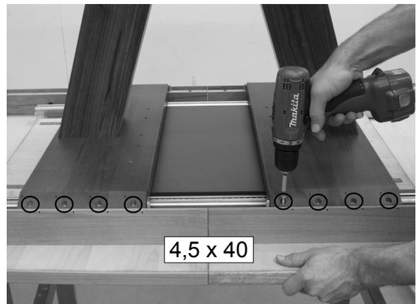
4. Die Unterbauten beidseitig mit 8 Schrauben fixieren.
