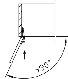
T11 Bei Türmontage das Scharnier einhängen, bis Anschlag öffnen und anschließend festschrauben.
