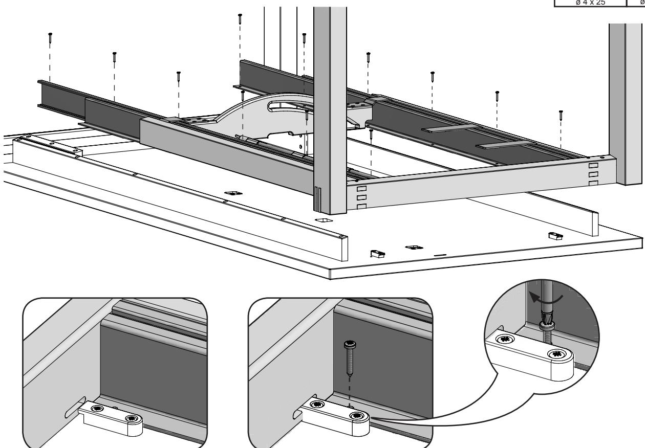
**5 Schritt 5 - 11: Montage der Einlegeplatten**
