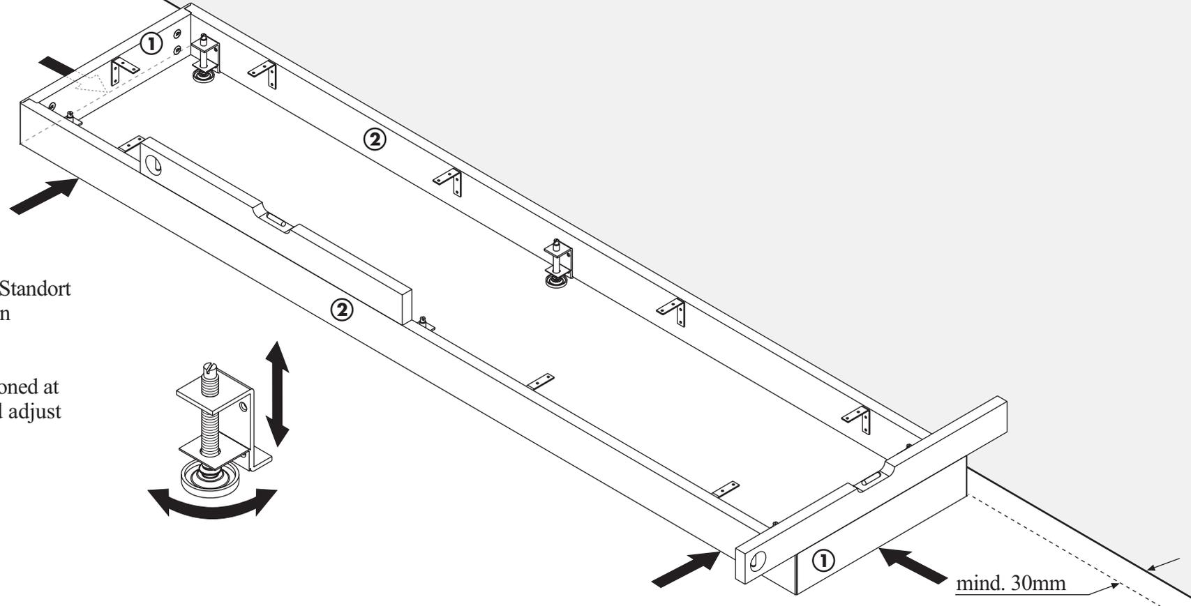
Den Sockel am späteren Standort positionieren, und mit den Stellfüßen ausrichten.
