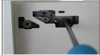
Mit Betätigung der vorderen Schraube wird die Fronteinstellung in horizontaler Richtung vorgenommen!
