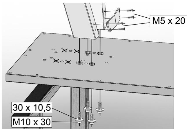
3. Die Bolzen der Tischbeine in die im Bild gezeigten Löcher stecken. Jeden Bolzen mit mit einer Unterlegscheibe und einer Mutter fixieren.
