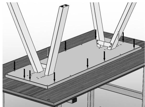
4. Die Sperrholz-Platte des vormontierten Unterbaus nun wieder an den Oberbau schrauben. Auch die zusätzlichen Spax-Schrauben eindrehen.
