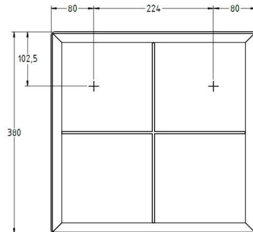
2. Hierzu werden 2 Bohrungen mit 8mm Durchmesser im entsprechenden Abstand der Regalhöhe (siehe Abbildung) gebohrt.
