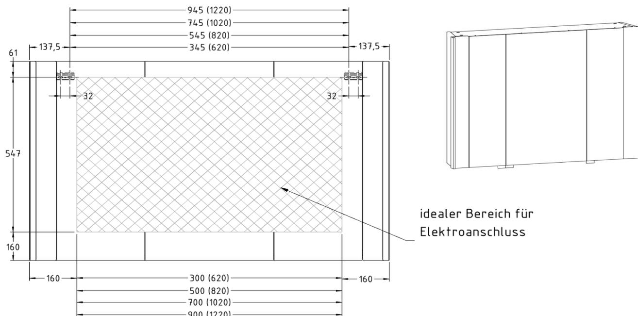
4. Nun kann der Spiegelschrank aufgehängt werden und anschließend von innen durch die Bohrungen, sowohl in der Höhe (siehe Abbildung 2 / Seite 6), als auch in der Tiefe (siehe Abbildung 3 / Seite 6) ausgerichtet werden.
