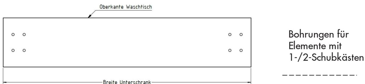
3. Die Oberkante der Bohrschablone entspricht der Oberkante des Mineralstein-Waschtisches.
