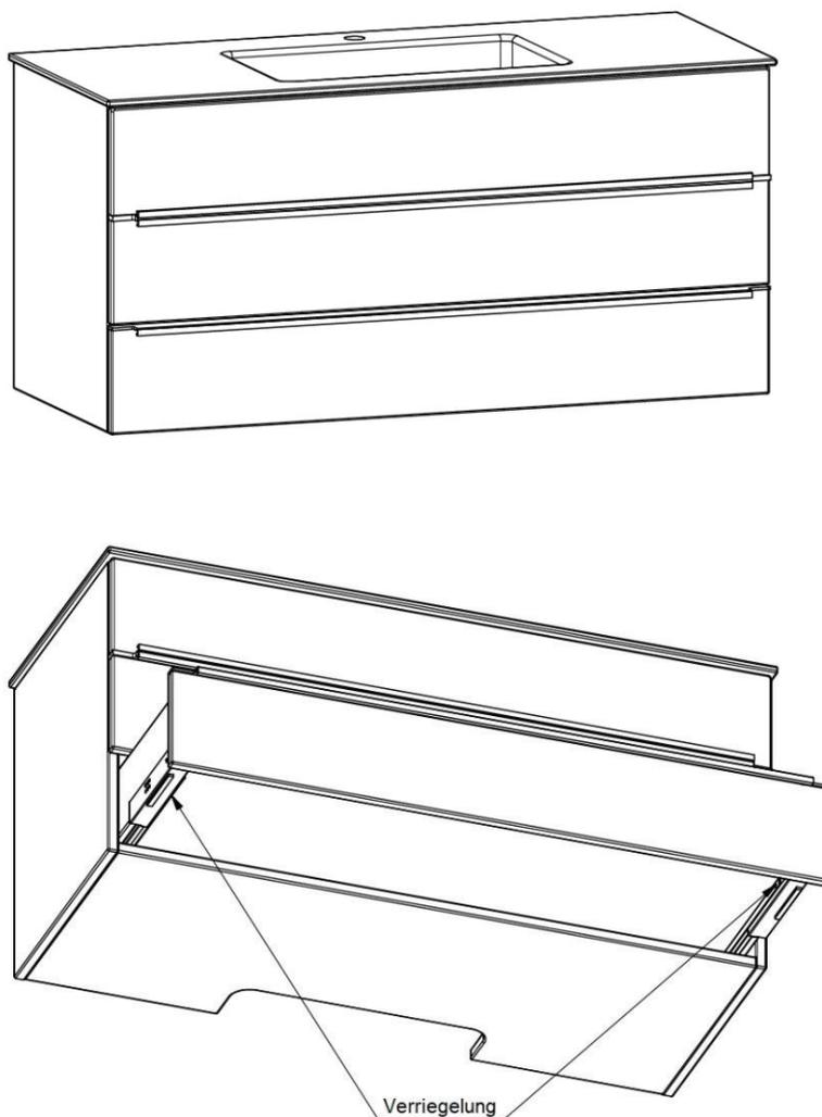
1. Nachdem der Unterschrank aus der Transportverpackung entnommen worden ist, müssen die Schubkästen heraus genommen werden. Hierzu muss die Verriegelung unterhalb der Schubkästen gelöst werden (siehe Abbildung). Position der Schubkästen für das spätere Wiedereinsetzen beachten!
