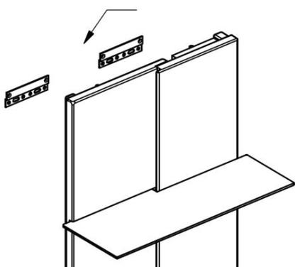
3. Nachdem die mitgelieferten Wandschienen an der Wand montiert wurden (Schrauben 5x80mm), kann das Hängepaneel aufgehängt werden.
