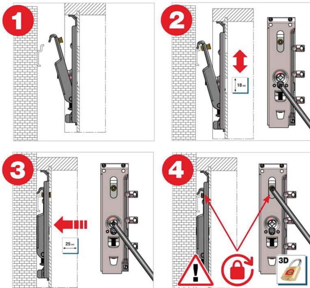
5. Die Aushebesicherung muss eingeschraubt werden (siehe Abbildung 4), hierdurch wird ein unbeabsichtigtes Aushängen des Schrankes verhindert.
