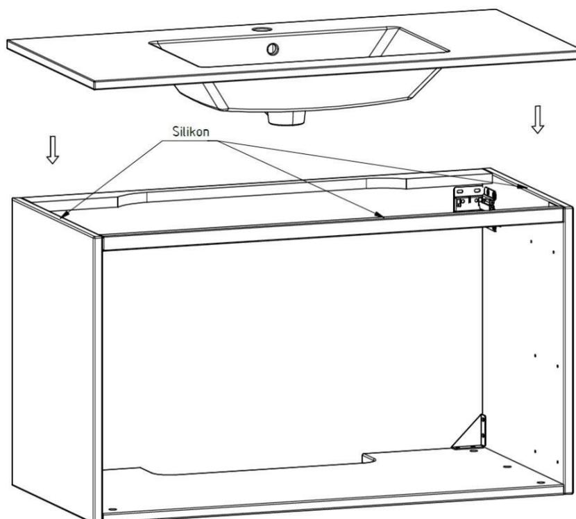
8. Danach wird der Waschtisch mit neutral vernetztem Silikon auf den Unterschrank aufgelegt und zur Wand abgedichtet.
