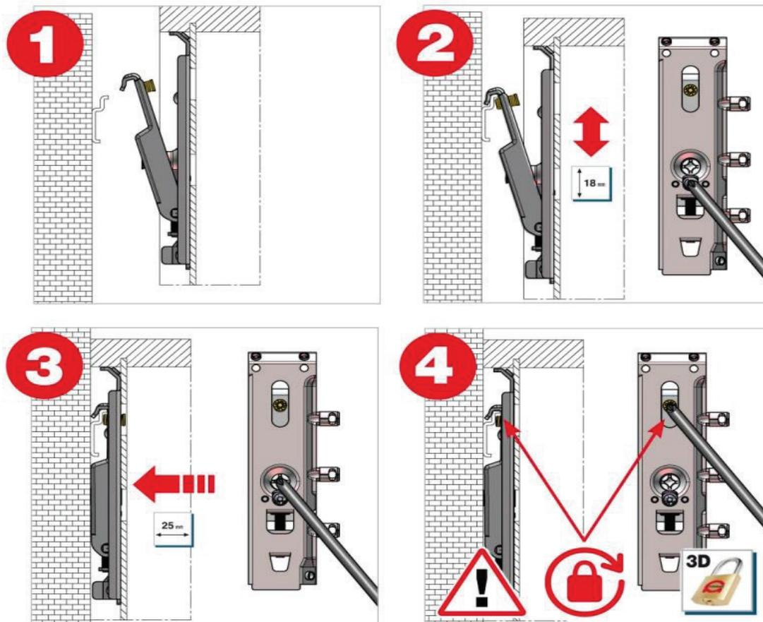
5. Jetzt muss die Aushebesicherung eingeschraubt werden (siehe Abbildung 4), hierdurch wird ein unbeabsichtigtes Aushängen des Schrankes verhindert.
