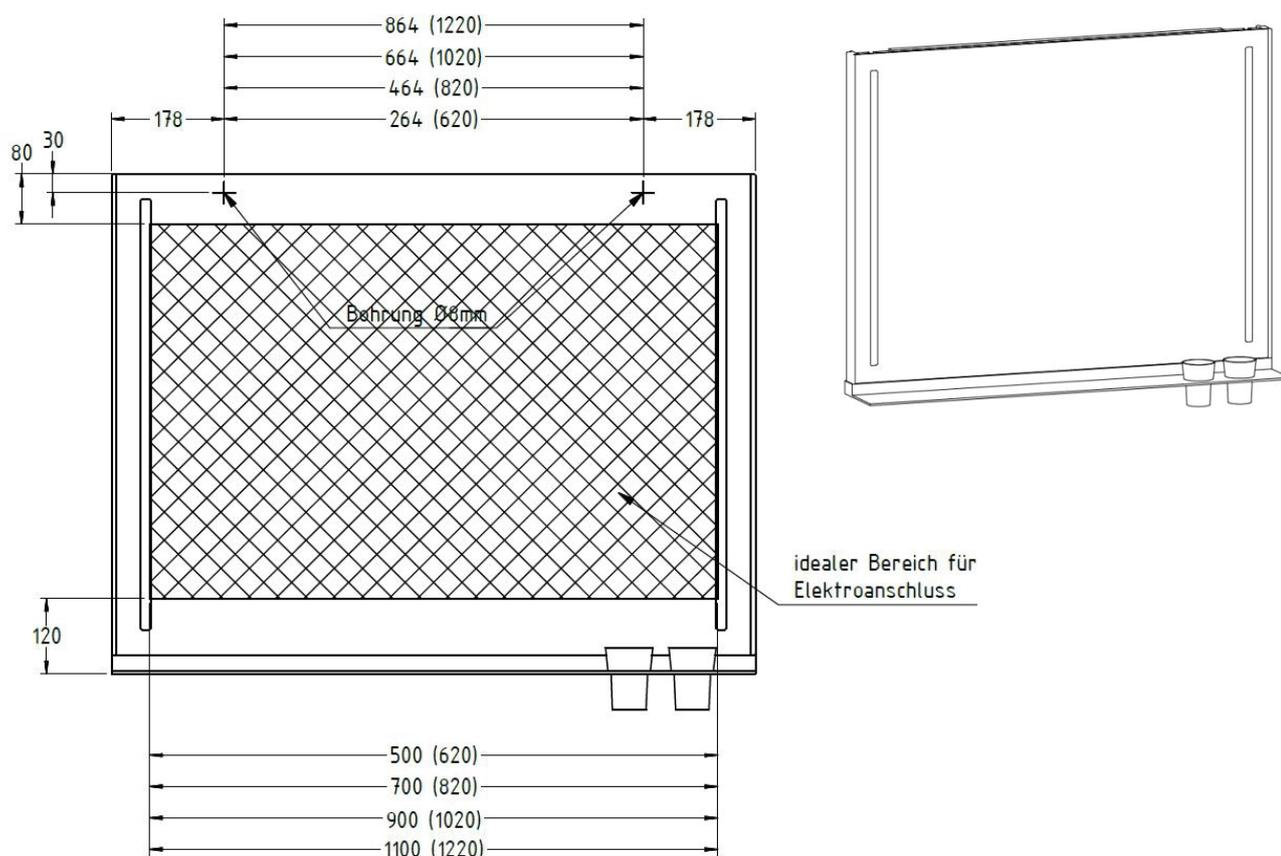
3. Nachdem die mitgelieferten Haken (5,8x50mm) in die Wand montiert wurden, kann der Hängespiegel aufgehängt werden. Durch Verstellen des Aufhängebeschlages kann der Hängespiegel in der Höhe ausgerichtet werden.
