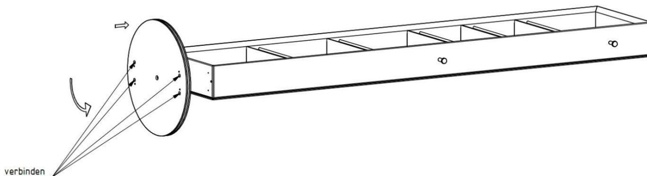
3. Standspiegel aufstellen, die Haken mittels mitgelieferte Gewindestifte in die vormontierten Muffen montieren.
