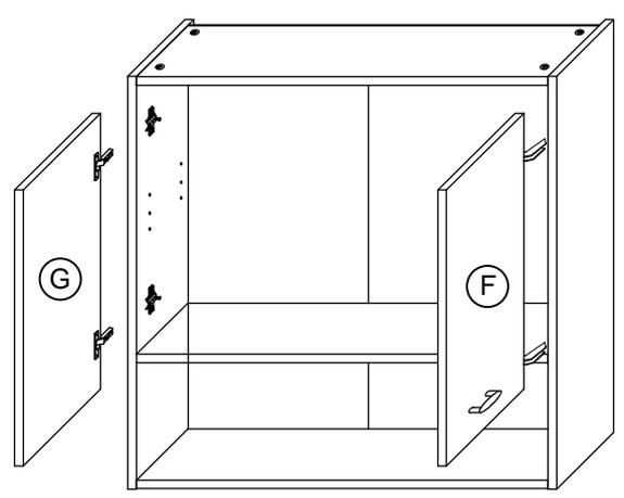
**T11** Bei Türmontage das Scharnier einhängen, bis Anschlag öffnen und anschließend festschrauben.
