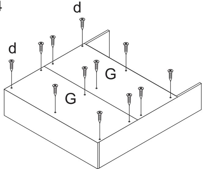
Halten Sie bei der Montage der Schrauben einen Abstand von ca. 7mm zum oberen und unteren Rand ein.
