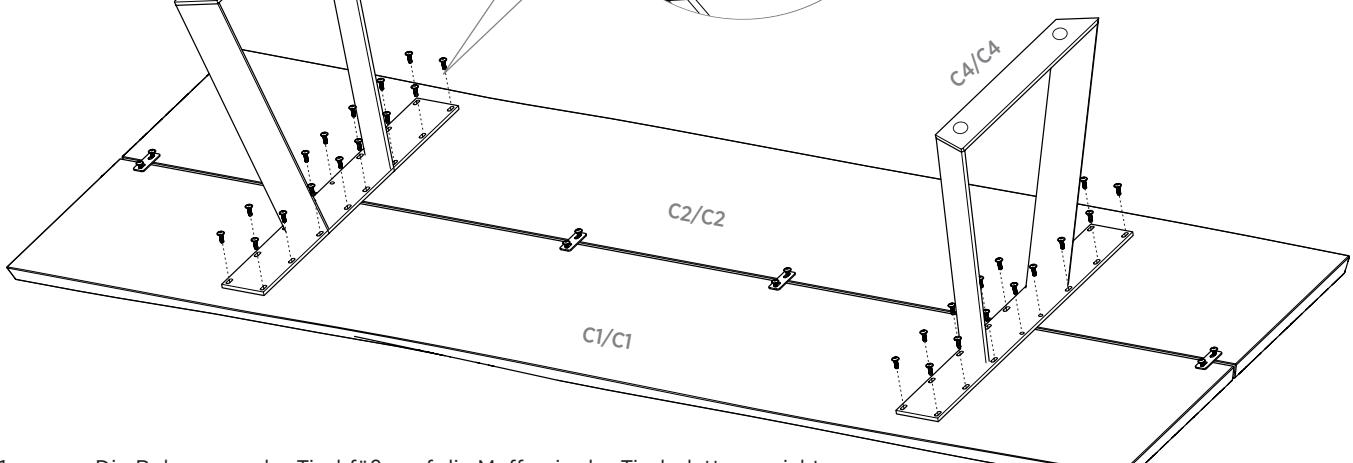
1. Die Bohrungen der Tischfüße auf die Muffen in der Tischplatte ausrichten.
