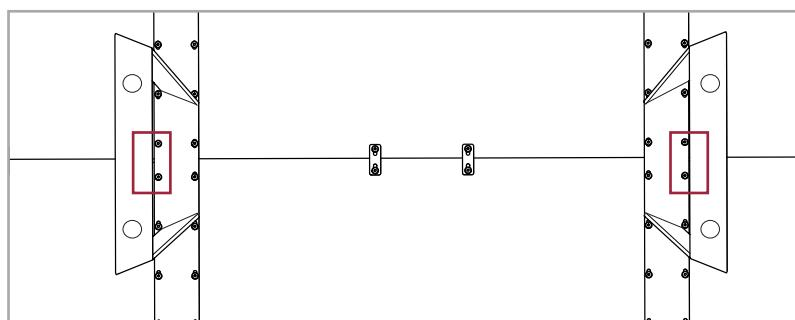
Die markierten Schrauben nur eindrehen, wenn der Spalt zwischen den beiden Tischplatten gleich Null sein soll.
