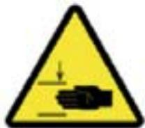
Existe peligro de lesiones por los movimientos de las columnas de elevación. Si al maniobrar el bastidor de mesa hay personas u objetos en su radio de acción, existe el peligro de aplastamiento o peligro de daños para los objetos.
