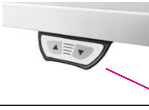
Appuyer sur la touche « DOWN » de la commande et maintenir la touche appuyée. Après env. 10 secondes, la table se déplace sur la position de fin de course inférieure, avant d'émettre un léger « clic ». Si la touche est relâchée avant que le processus ne soit entièrement achevé, le processus de réinitialisation est interrompu et doit être repris depuis le début.
