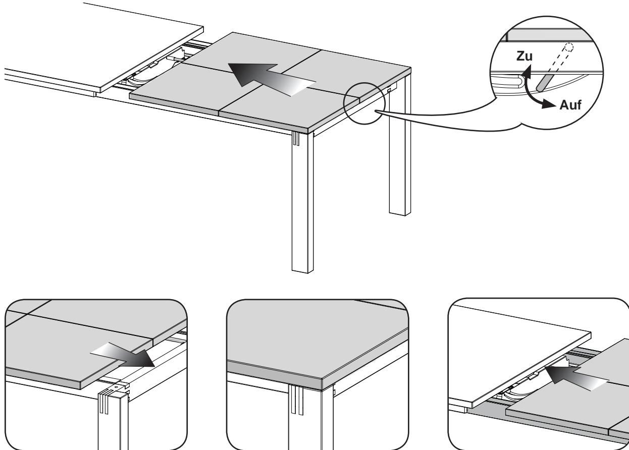
11 Ausrichten und Fixieren der Einlegeplatten
