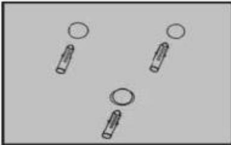
III. Bringen Sie die Halterung mit drei ST4\*35mm-Schrauben an und vergewissern Sie sich, dass die einzelnen Punkte gut befestigt sind.
