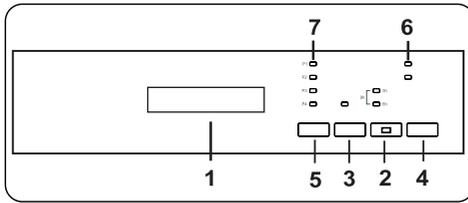
Schalten Sie die Spülmaschine ein, indem Sie die Taste „Ein/Aus“ (4) drücken. Die Lampe „Ein/Aus“ leuchtet, solange die Spülmaschine eingeschaltet ist. Wählen Sie über die Taste „Programm“ (5) das entsprechende Programm aus.
