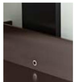
Der Infrarotrepeater transportiert die Signale der Fernbedienung störungsfrei ins Möbelinnere. // *The infra-red repeater transfers your remote control's signals to the furniture's inside without any losses.*
