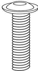
Flanschkopfschraube 8x30 mm
