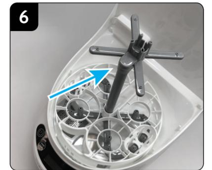
6 Richten Sie die Rippe in der oberen Sprühdüse am Mittelrohr aus und drücken Sie die oberen Sprühdüsen ganz nach unten.
