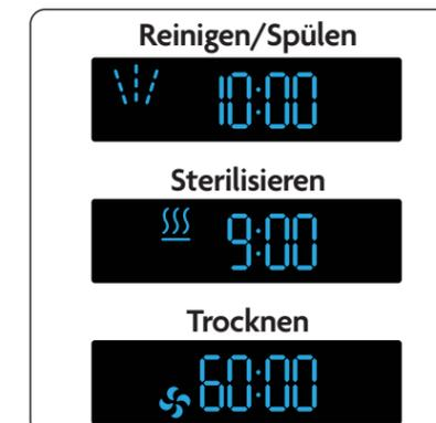
Das Display zeigt das Symbol des jeweiligen Arbeitsgangs und einen Timer an. Sobald der letzte Arbeitsgang abgeschlossen ist, schaltet sich der Bottle Washer Pro automatisch ab.
