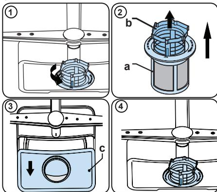
Drehen Sie die Filterkombination zum Entfernen und Reinigen gegen den Uhrzeigersinn und nehmen Sie sie durch Anheben nach oben heraus (1). Ziehen Sie den Grobfilter aus dem Mikrofilter heraus (2). Ziehen Sie dann den Metallfilter (3) heraus und entfernen Sie ihn. Spülen Sie den Filter mit viel Wasser ab, bis er frei von Rückständen ist. Bauen Sie die Filter wieder zusammen. Setzen Sie den Filtereinsatz wieder ein und arretieren Sie ihn im Uhrzeigersinn (4).
