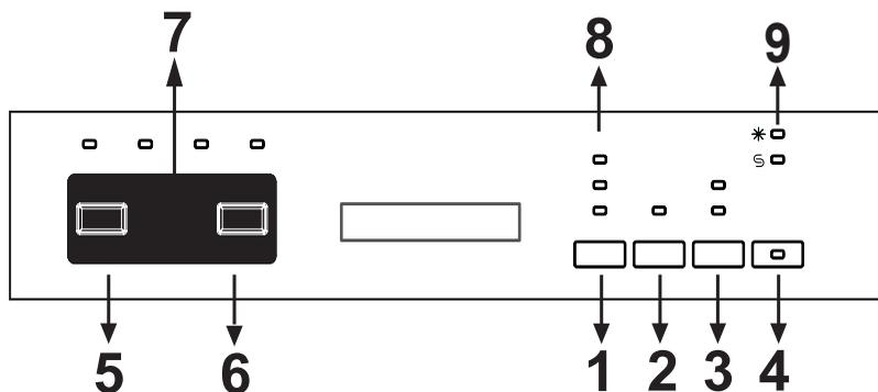
Sie können die Ein-/Aus-Taste (4) betätigen, um das Gerät auszuschalten. Die Ein/Aus-Leuchten leuchten, solange die Maschine eingeschaltet ist. Drücken Sie zum Einstellen des gewünschten Programms die Programmtaste (5).
