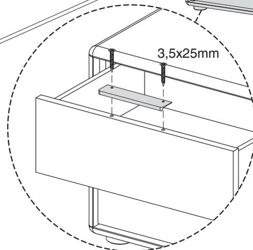
Haben Sie zusätzlich den Paneel-Aufsatz 1672 / 1673 / 1674 gewählt, sollte dieser auf die Konsole geschraubt werden, **BEVOR** die Konsolen an das Bett montiert werden (siehe Seiten 24 - 26)
