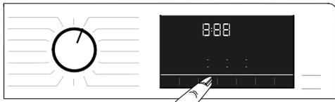
Wählen Sie die gewünschten Zusatzfunktionen, bevor Sie das Programm starten. Bei Auswahl eines Programms leuchten die Symbole der kompatiblen Zusatzfunktionssymbole auf.
