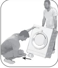
Zum Entfernen der Transportstabilisatoren neigen Sie die Maschine etwas nach hinten. Entfernen Sie die Stabilisatoren durch Ziehen am Band. Führen Sie diese Arbeit nicht alleine durch.
