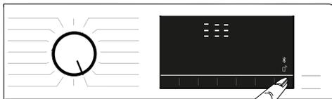
Wenn die Fernsteuerung aktiv ist, können Sie die Waschmaschine direkt am Gerät nur ausschalten und die Programmfolge beobachten. Alle sonstigen Funktionen mit Ausnahme der Kindersicherung steuern Sie über die Applikation.
