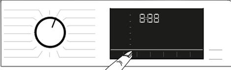
Nachdem ein Programm ausgewählt wurde, wird die empfohlene Schleuderdrehzahl des gewählten Programms in der Anzeige **Schleuderdrehzahl** angezeigt.
