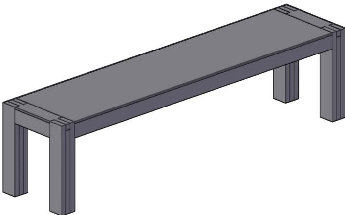
3. Fixieren Sie alle Schrauben einer Tischseite zunachst leicht, erst dann die schrauben fest anziehen.
