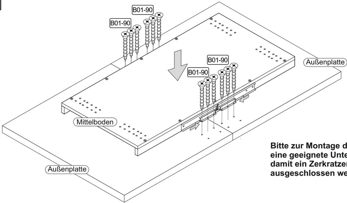
Bitte zur Montage der Tischplatte eine geeignete Unterlage verwenden, damit ein Zerkratzen der Oberplatte ausgeschlossen werden kann!
