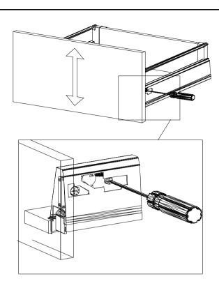
Mit Betätigung der hinteren Schraube wird die Front in der vertikalen Richtung eingestellt!
