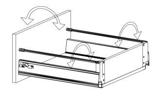
Mit Drehung der STR-Reling nach "links" wird die Front "waagrecht" eingestellt.
