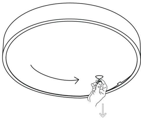
7. Instalați unul câte unul pe celelalte proiecții până când capacul este complet montat.
