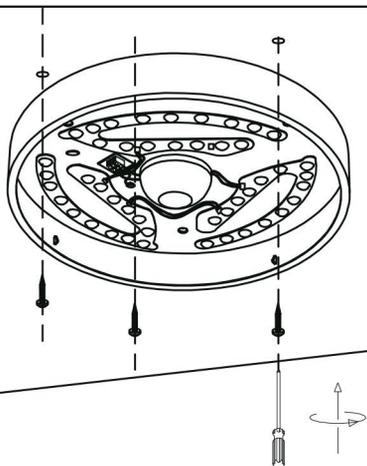
3. Nainštalujte svetidlo a na skúšku zapnite.
