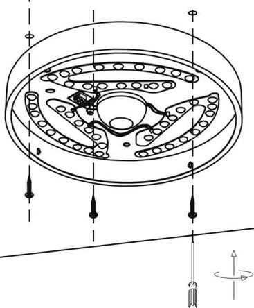
3. Nainstalujte svítidlo a zkušebně zapněte.
