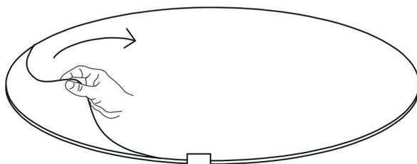
4. Odstráňte ochrannú fóliu z krytu svetidla a pripravte si ho k nasadeniu lesklou stranou von.
