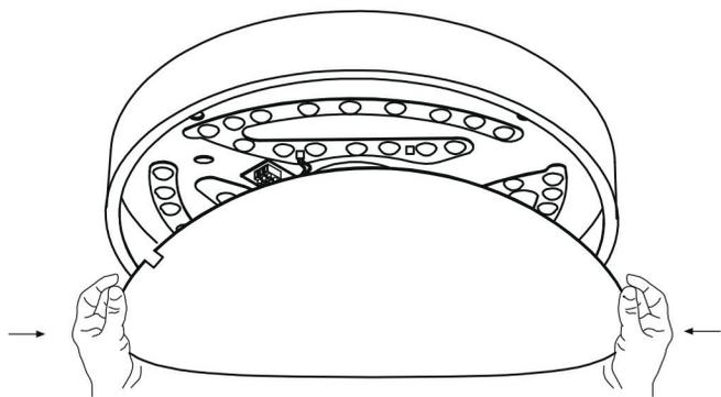
5. Îndoți ușor capacul și introduceți jumătate din capac în corpul de iluminat, apoi împingeți capacul pentru a intra în corpul de iluminat.
