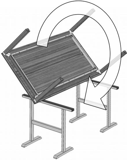
4. Den Tisch wenden, ohne die FüÙe zu belasten und dann gleichzeitig alle 4 Tischbeine auf dem Boden absetzen.
