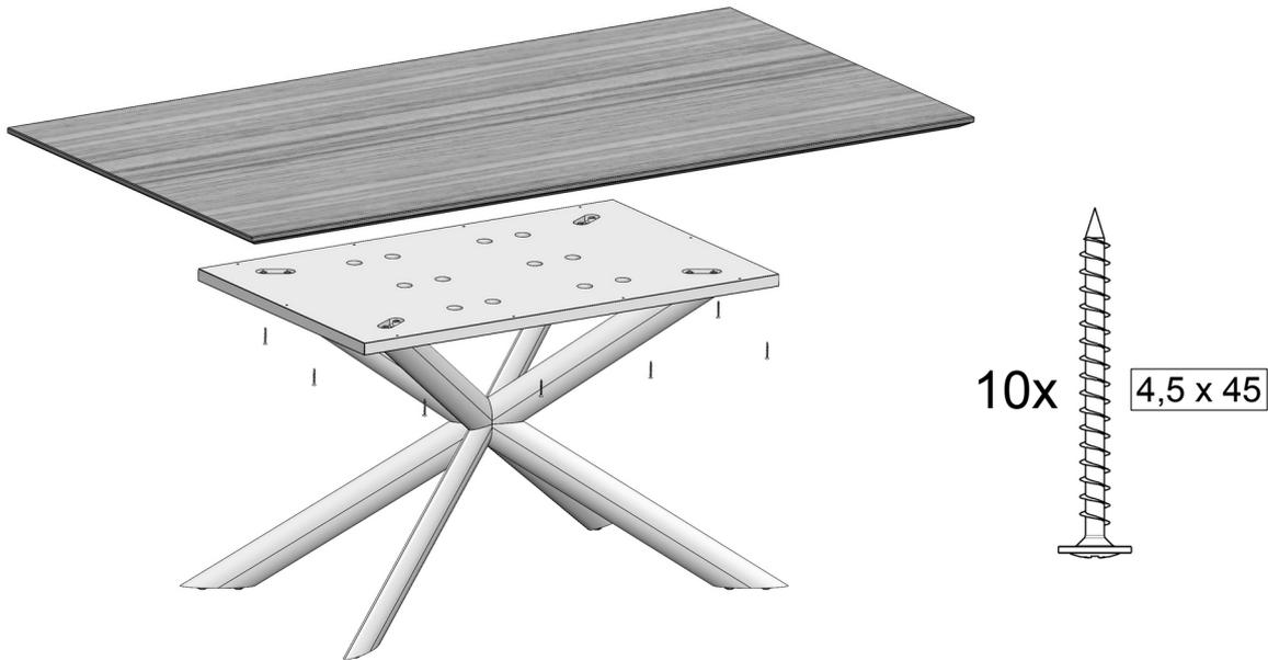
4. Den Oberbau auf die Trägerplatte legen und verschrauben. Die vorhandenen 4 Bohrungen zur Positionierung wieder verwenden.
