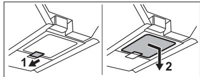
2. Schiebe die Tropfschale vertikal nach unten. Achte darauf, dass kein Wasser verschüttet wird.
