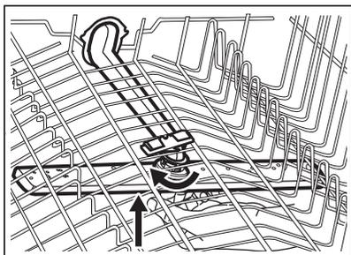
3. Lavez le bras d'aspersion sous l'eau courante. Utilisez un outil pointu comme un cure-dent pour extraire toutes les particules de saleté incrustées dans les orifices. Faites couler de l'eau dans les orifices pour éliminer les particules de saleté se trouvant à l'intérieur.
