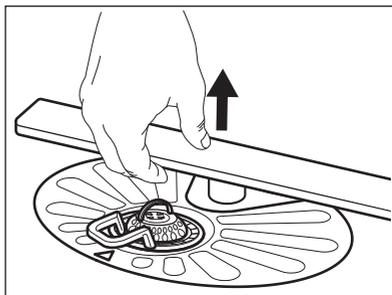
2. Lavez le bras d'aspersion sous l'eau courante. Utilisez un outil pointu comme un cure-dent pour extraire toutes les particules de saleté incrustées dans les orifices. Faites couler de l'eau dans les orifices pour éliminer les particules de saleté se trouvant à l'intérieur.
