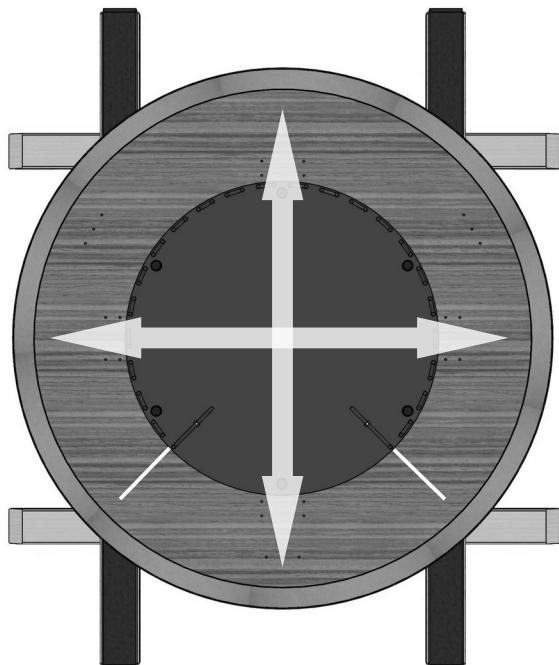
3. Den Unterbau mittig auf der Platte ausrichten.
