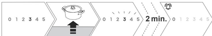
Das Gerät erkennt automatisch einen fehlenden Topf in einer aktiven Kochzone. Bei einer fehlenden Pfanne blinkt der gesamte Schieber mit der eingestellten Leistung. Während dieser Zeit werden die entsprechenden Timer auf der Kochzone, in der sich keine Pfannen befinden, vorübergehend pausiert.
