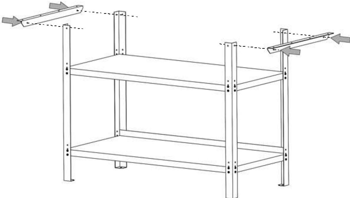
Schrauben Sie die beiden Verbindungswinkel (N2) an die obere Seite der Tischbeine.
