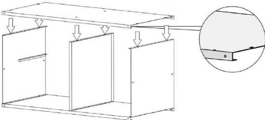
Schrauben Sie jetzt den Deckel (K3) auf die Konstruktion. Verschrauben Sie die Mittelwand nun auch mittig mit dem Deckel. Achten Sie darauf, dass der Deckel mit den Kanten nach unten ausgerichtet ist!
