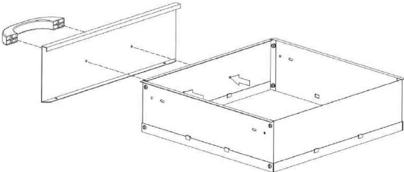
Schrauben Sie die Schubladenblende (S1) und den Schubladengriff (S7) mit Hilfe von zwei Schneidschrauben (25) wie abgebildet an die Schubladenfront. Ziehen Sie alle Schrauben jetzt fest an.
