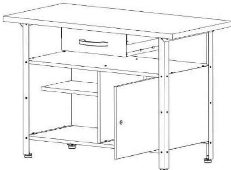
Bringen Sie die Tür in Position zu den Türsplint-Löchern im Werkbank-Körper und stecken oben und unten je einen Federsplint (D4) in die vorgesehenen Türlöcher mit der Feder in der Türsplint-Vorrichtung (siehe Detail-Abbildung).
