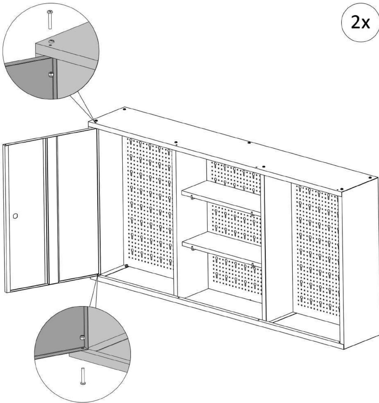
Verschrauben Sie die Tür oben und unten mit dem Deckel und Boden. Die Schraubenhöfe sitzen außen, die Stopmuttern innen.
