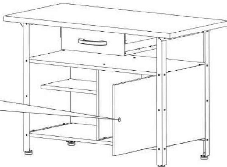
Stecken Sie den Schließzylinder des Schlosses (L) durch die in der Tür vorgesehene Öffnung und fixieren Sie ihn wie in der Abbildung. Prüfen Sie vorher, ob die Schließrichtung korrekt ist.
