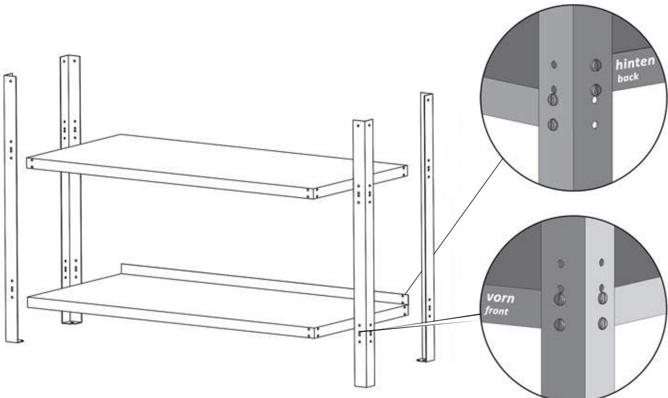
Schrauben Sie mit Hilfe von sechzehn Schraubensets (8) alle vier Tischbeine (N1) zuerst an den unteren Fachboden (N4). Nutzen Sie an der Vorderseite die beiden untersten Löcher, an der Rückseite die beiden obersten. Die Schraubenköpfe platzieren Sie außen, die Muttern und Unterlegscheiben innen. Bringten Sie nun auch den oberen Fachboden (N3) an den Tischbeinen an. Hier können Sie die gewünschte Höhe selbst wählen.
