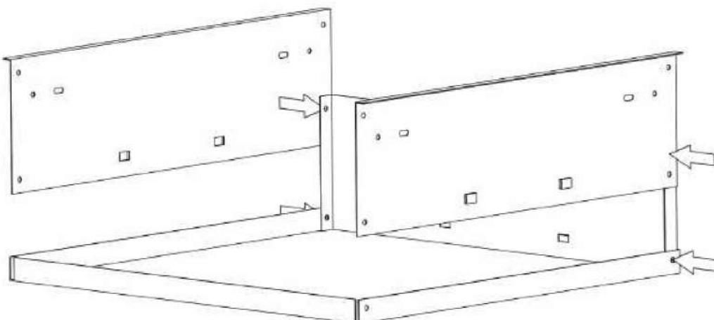
Schrauben Sie jetzt beide Schubladenseitenwände (S5), die Schubladenumwand sowie den Schubladenboden zusammen. Achten Sie beim Verschrauben der Einzelteile darauf, dass die Schraubenköpfe außen sitzen und die Muttern sowie Unterlegscheiben innen sitzen.
