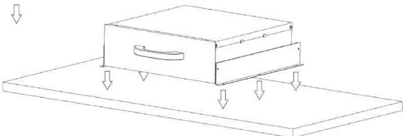
Schrauben Sie die Schubladen-Konstruktion mit Hilfe von sechs Schneidschrauben (25) auf die inneren Markierungen der Unterseite der Arbeitsplatte (AP).
