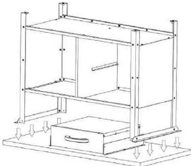
Schrauben Sie den Korpus mit Hilfe von acht Schneidschrauben (25) auf die äußeren Markierungen der Unterseite der Arbeitsplatte (AP).
