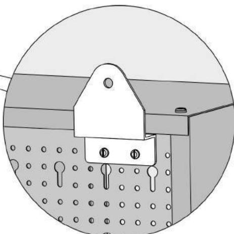
Befestigen Sie die beiden Aufhängungen (7) wie abgebildet mit je zwei Schraubensets links und rechts an der Rückwand.
