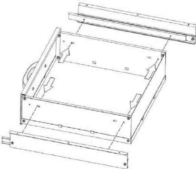
Schrauben Sie nun die fertige Schublade an die Schubladenführungen der Schubladenaufhängungen. Ziehen Sie jetzt noch einmal alle Schrauben der Schublade fest an.
