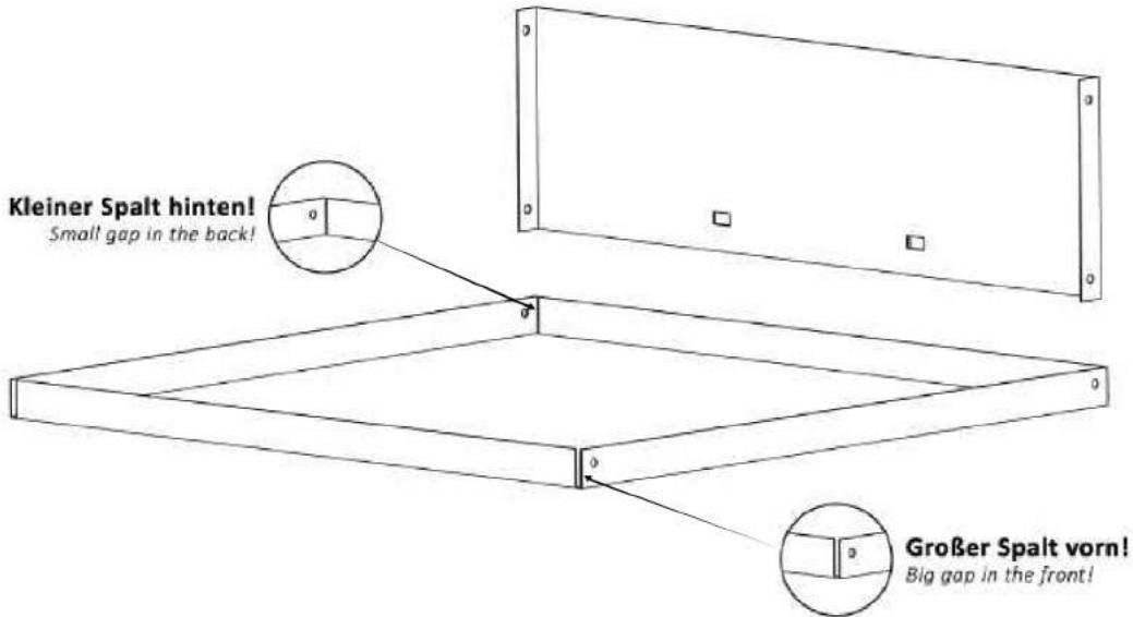
Setzen Sie die Schubladenumwand (S6) auf den Schubladenboden (S3). Schrauben Sie die beiden Teile noch nicht zusammen!
