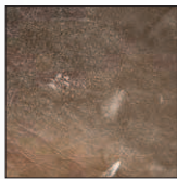
Aufbrechen der Oberfläche bei gedecktem Leder durch mangelnde Pflege
