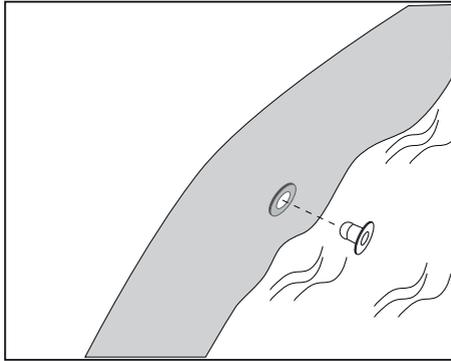
7. Schließen Sie die Filterpumpe an. Das korrekte Anschließen wird in der Bedienungsanleitung der Filterpumpe erklärt.
