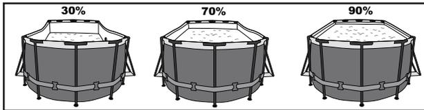
2. Überprüfen Sie während der Befüllung des Pools, dass sich das Wasser an keiner Seite sammelt, um sicherzustellen, dass der Pool eben platziert ist.
