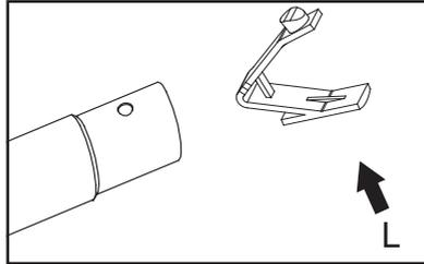
3. Verbinden Sie zunächst die Querstange B mit der Querstange C, anschließend die Querstange C mit der Querstange D. Wiederholen Sie diesen Schritt auf der gegenüberliegenden Seite.
