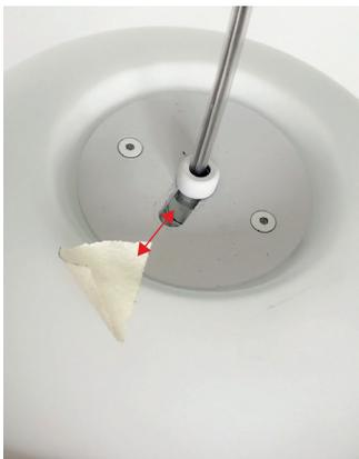
**7** Schlitz auf die Markierung exakt ausrichten
