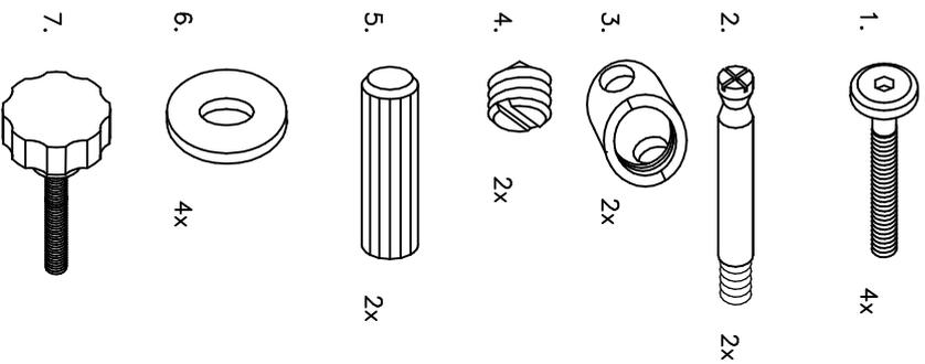
1. Schrauben Nr.2 In die Wange(A) schrauben dübel Nr.5 in die Wangen Klopfen dann die Hülsen Nr.3 in den Steg(B) legen und mit Wange(A) mit schraube Nr.4 verschrauben.
