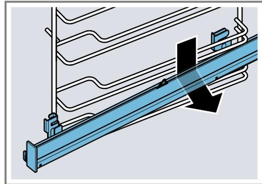
5. Die Auszugsschiene reinigen.
