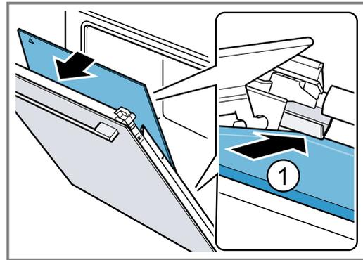
2. **Hinweis:** Die Zwischenscheibe positioniert sich automatisch durch die Drehbewegung der Abstandhalterung.
