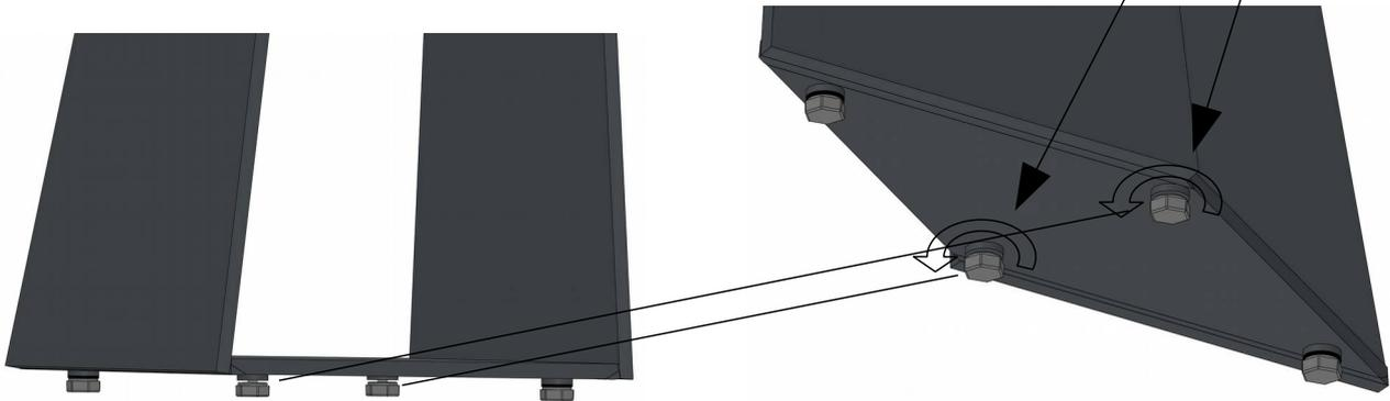
6. Die beiden mittleren Stellfüße der Festseite so weit herausdrehen, bis sie Kontakt zum Fußboden haben.
