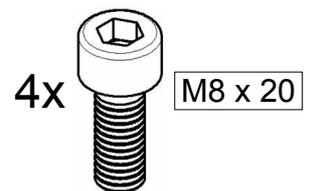
3. Die beiden Unterbauten verschrauben.
