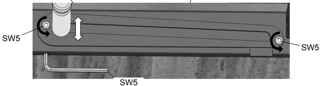
11. ... die beiden äußeren Inbusschrauben etwas lösen. Nun durch Drehen der inneren Inbusschraube die Höhe der Drehstange einstellen. Anschließend die beiden Inbusschrauben wieder festziehen.
