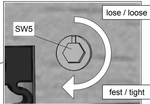
8. Kerbe nach außen: geringe Vorspannung
