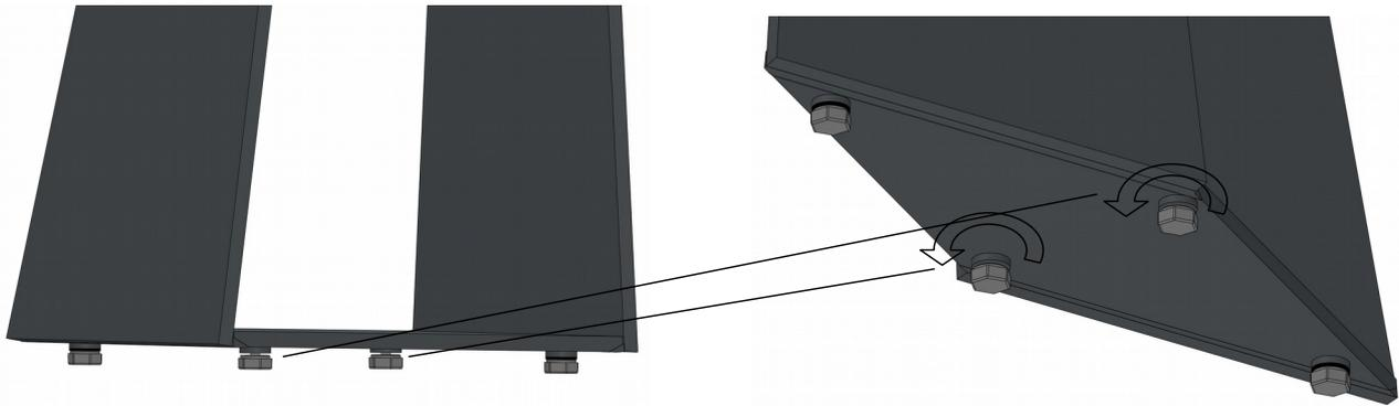
5. Die beiden mittleren Stellfüße so weit herausdrehen, bis sie Kontakt zum Fußboden haben.
