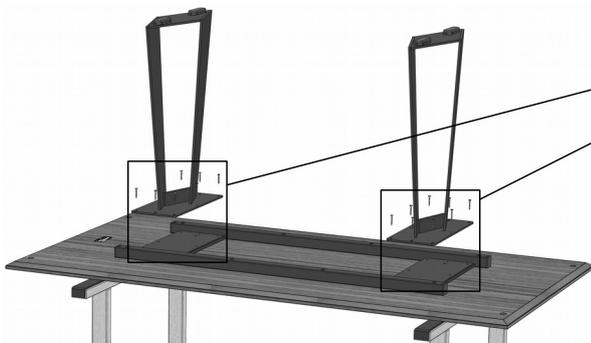
3. Die beiden Unterbauten verschrauben.
