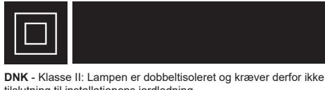
**DNK - Klasse II:** Lampen er dobbeltisolert og kræver derfor ikke tilslutning til installationens jordledning.
